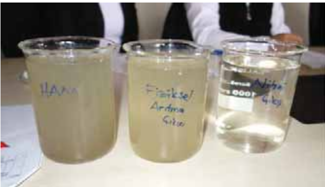
Şekil 262. Soldan Sağa; Giriş Ham Atıksu, Fiziksel Arıtma Sonrası ve Deşarj Edilen Nihai Çıkış Suyu
